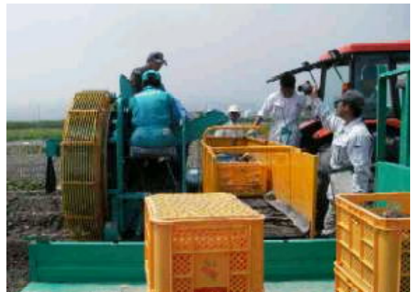
タンク内に20kgコンテナを置いて、直接コンテナに集めることも可能です。
