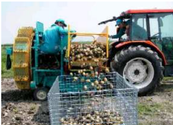
タンクは400kgの容量で、満杯になると大型のコンテナなどに移し運び出します。
