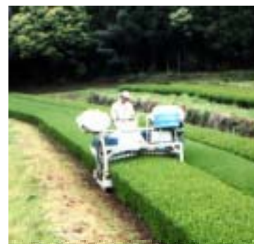
図1 テラス式茶園での小型乗用摘採機による摘採
