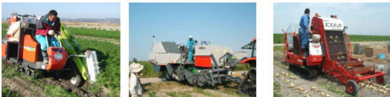
写真5 各収穫機（左：ニンジン，中：バレイショ，右：タマネギ）
