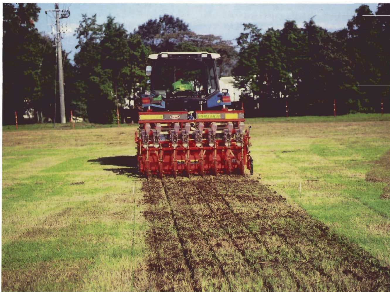
リノベータ（簡易草地更新機）によるバヒア草地へのイタリアン追播風景
