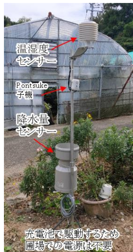
図2 月額利用料が不要な気象観測装置‘PonTsuKe’
