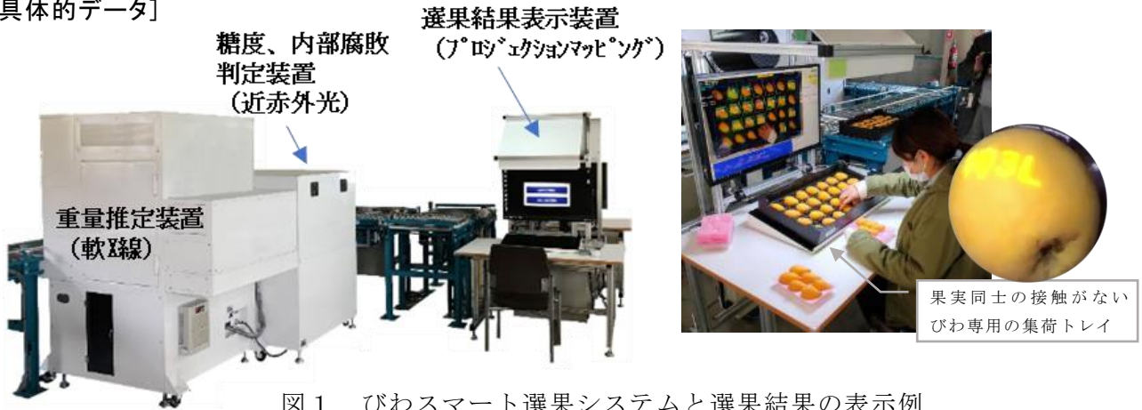
図1 びわスマート選果システムと選果結果の表示例
