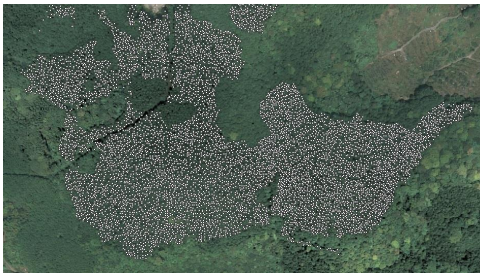
図 1 GISを活用した航空レーザ測量によるスギの単木位置図
