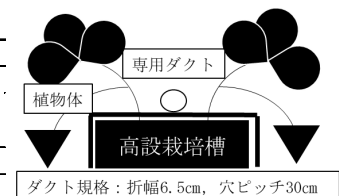
図 専用ダクト配置場所
