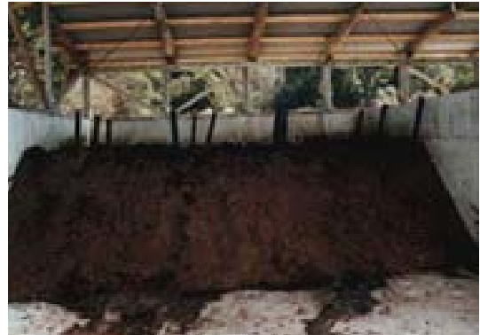
写真 1.3.18 通気管を設置した試験区
