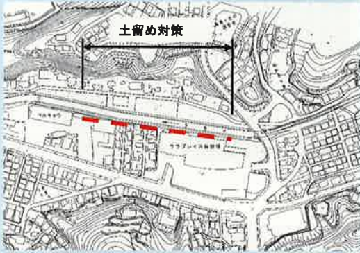
崩壊した地盤は透水性の高い砂質土層 背後は民家が隣接
