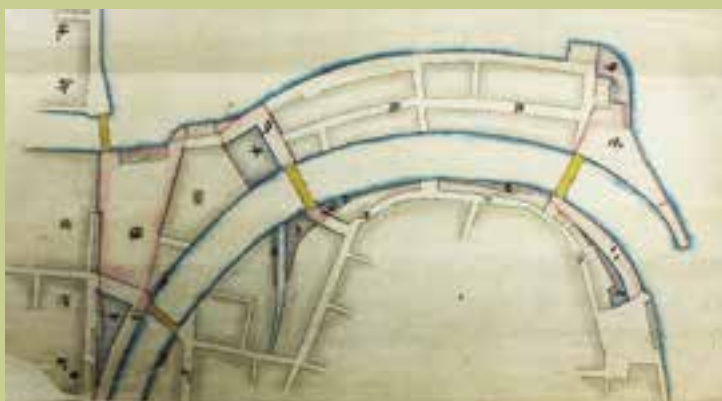
中島川変流工事の設計図。石黒五十二・内務省が作成。新地蔵に向けて直進していた中島川を、出島の背後（現在の状態）に変流した。（長崎歴史文化博物館所蔵）
