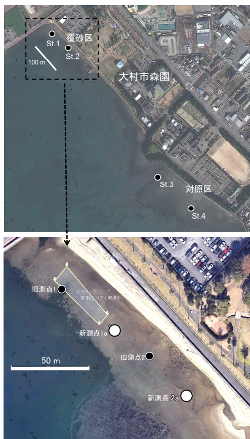
図2a 森園の調査地点位置図。平成30年度の覆砂区における調査は測点1aと2aで行った。
