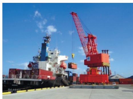
タイヤマウント式クレーン
