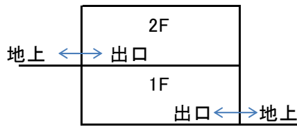
避難階のみなので 報告対象外
