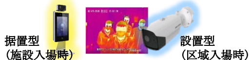
(評価基準22-②-図表J 感染症対策用スクリーニング資機材)
