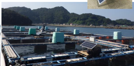
遠隔給餌監視システムの設置状況
