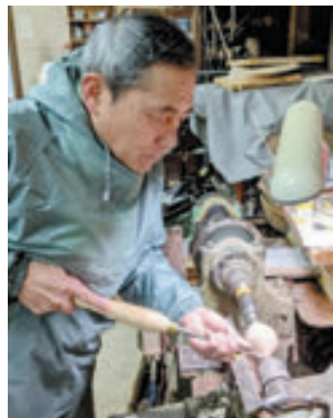
(左) 伐採後、2年間乾燥させたマテバシイ (右) 轆轤に固定した材をノミで削る作業
