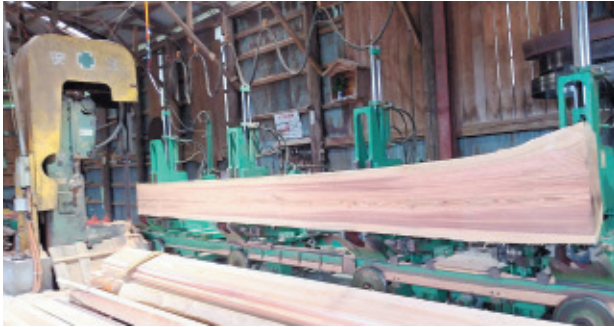
10 mの長材も裁断可能な製材機
