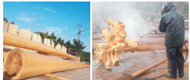
(左) スギの木の磨き丸太 およそ10mの特注品 (右) 持込みの槓の丸太を磨き、床柱に加工する様子
