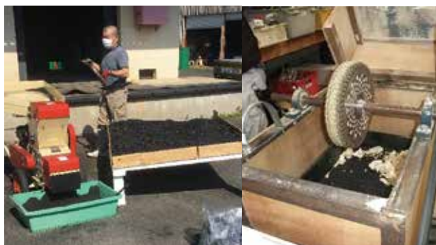
竹炭チップ作り(左)とお手製の竹粉碎機(右)
