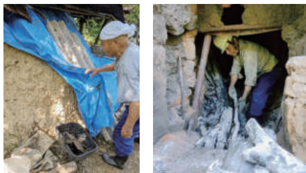
(左)窯の入り口を粘土で塞ぎ2週間冷やす (右)出来上がった木炭の窯出し作業
