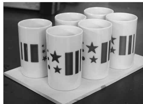
図2 生釉上へ転移（左：落剥 右：良好）
