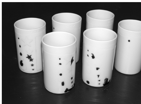
図2 生釉上へ転移（左：落剥 右：良好）
