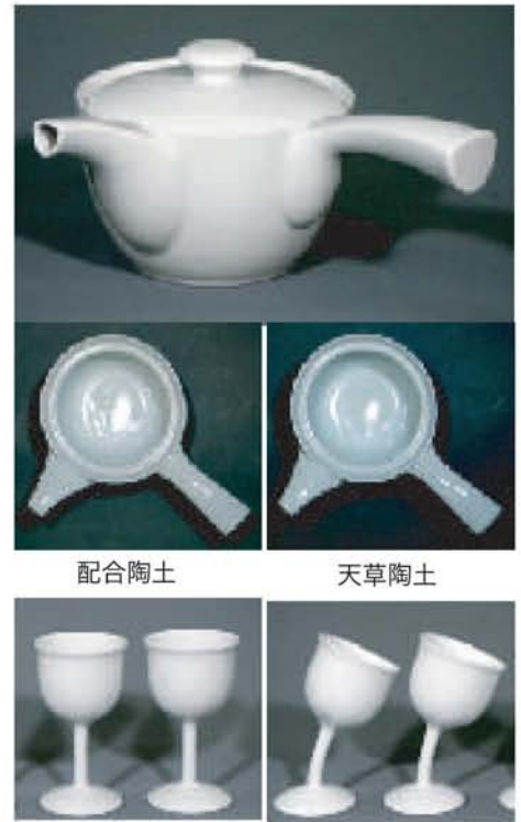
■上:「別焼き」による急須の変形比較 下:ワインカップの変形比較
