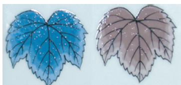
■写真1 持ち込まれた欠点 （上：チヂレ、下：泡）
