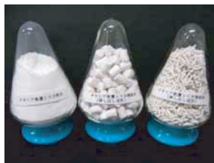
図2 開発した複合型光触媒粒子と押し成形ペレット
