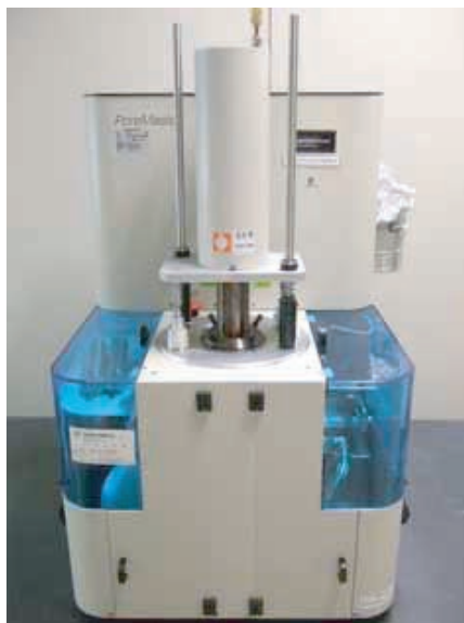
● 全自動細孔分布測定装置 (PoreMaster-60GT) (研究開発科 狩野)
