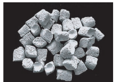
● 図1 牡蠣殻を原料としたリン除去材
