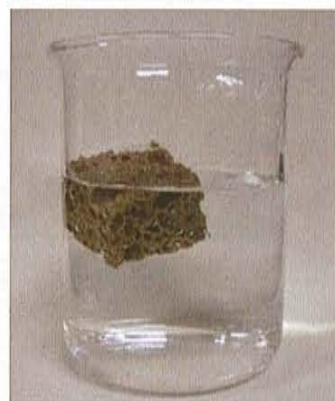
発泡剤を利用した多孔質固化体が水に浮く様子
