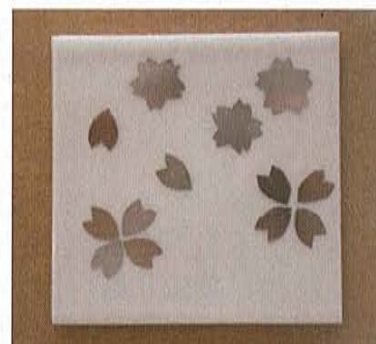
アルミニウム箔を陽極接合した陶磁器
