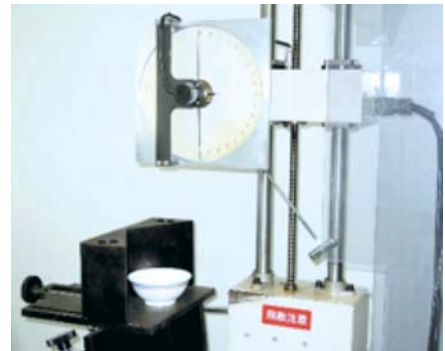
■ 衝撃試験機と測定の様子
