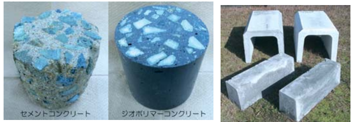
■ 左：5%-塩酸に70日浸漬した後の各硬化体の様子 右：試作したU字溝と縁石
