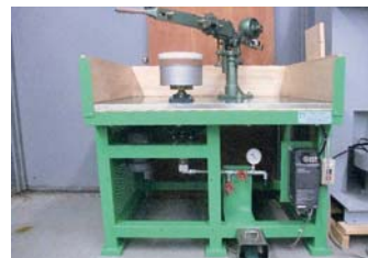
●機械ろくろ成形装置 「初心者でも簡単な飯碗や湯呑の成形ができます！」
