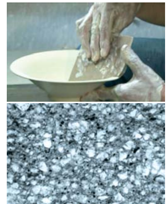
■ 上：手口ろ成形、下：成形した生地の顕微鏡写真(横幅0.4mm) 白い石英粒子の間の灰色の部分に微小な粘土粒子が充填している。
