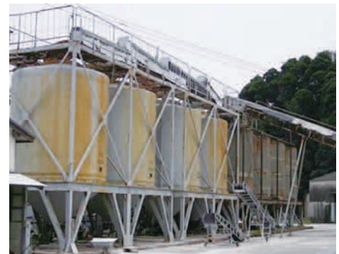
■ 図1 脱鉄プラント：上田陶石合資会社 (熊本県産業技術センター提供)
