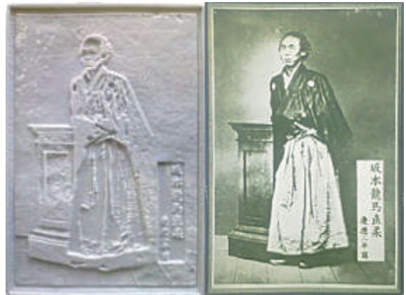
■ 図 1 画像の濃淡を磁器の厚みに変換し、光の透過量の違いで写真のような効果を再現した技術(右:光源を点灯)
