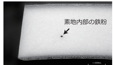
■図1 素地内部の鉄粉
