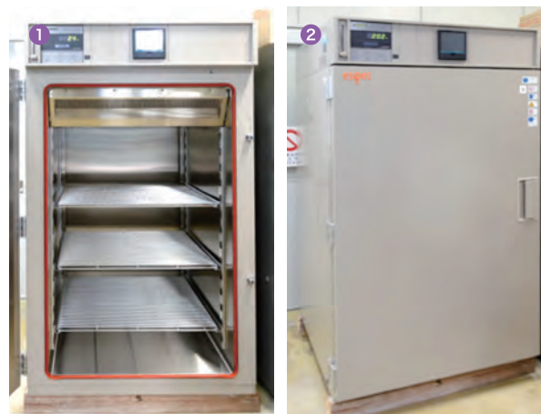
除湿乾燥機 ① 内部 ② 外観
