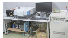
遠赤外線分光放射率測定装置
