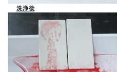
着色油の水による洗浄試験
