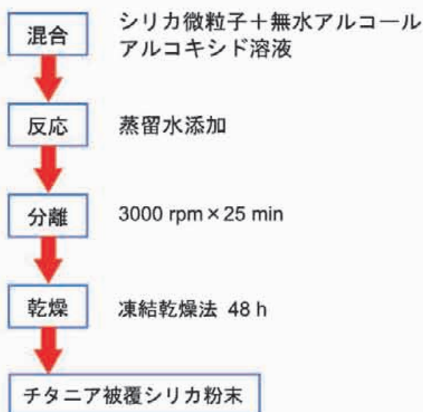
図1 チタニア被覆シリカ粉末の表面被覆方法
