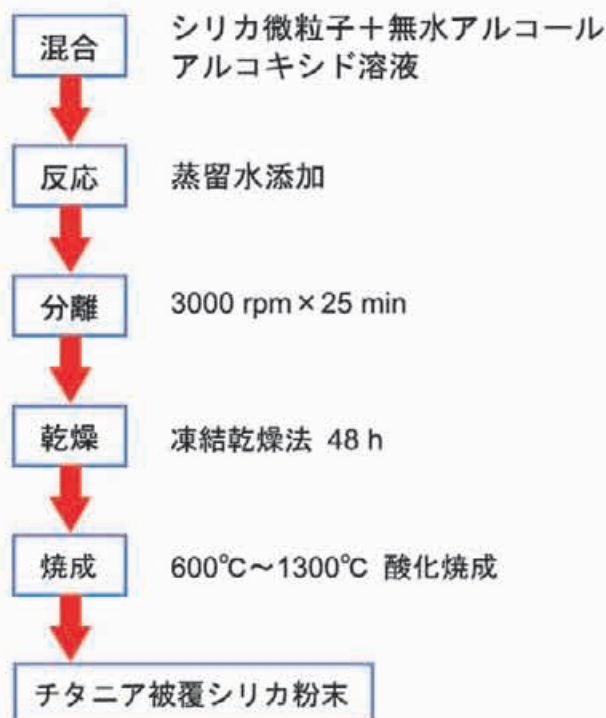
図1 チタニア被覆シリカ粉末の作製方法
