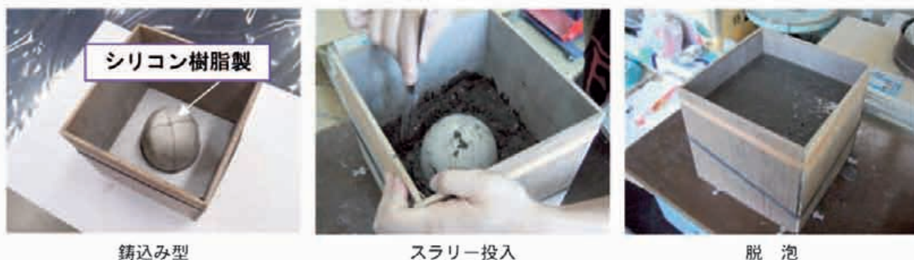
図2 凹み付きブロックの作製工程
