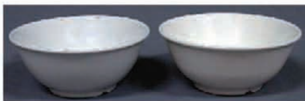
A社製 B社製 図4 衝撃強度測定用試験体
