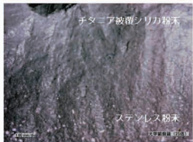
図5 チタニア被覆シリカ粉末とステンレス粉末傾斜ペレットの光学顕微鏡写真（断面）
