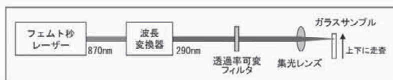
図1 紫外レーザー光照射試験の概略図
