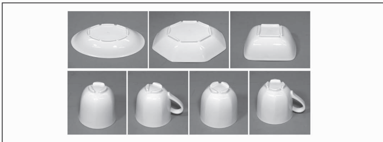
図3 製品開発例（圧力成形による楕円・四角・八角の皿・鉢、ローラーマシンによる面取りカップ）
