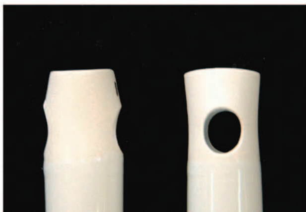
図5 吊し焼成による吊し穴部分の変形
