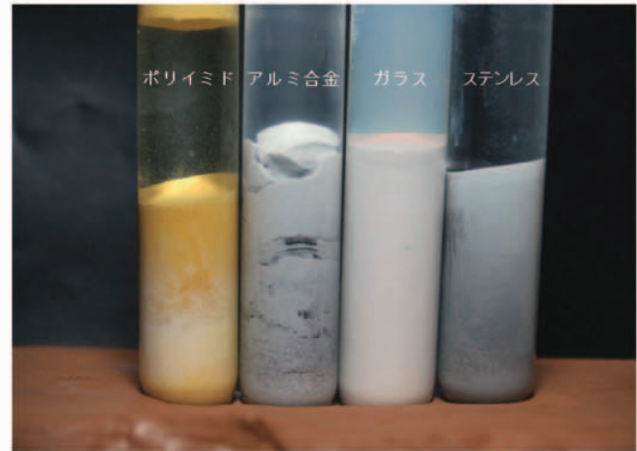
図3 遠心分離機を利用した各種傾斜材料
