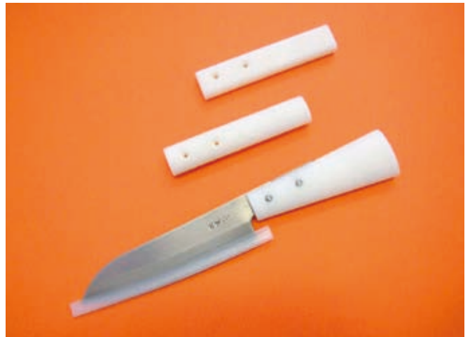
図3 3次元プリンタで製作した包丁のグリップ各種
