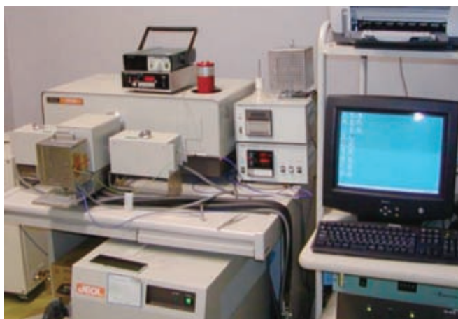
図1 遠赤外線放射率測定装置 (日本電子製、JIR-E500)
