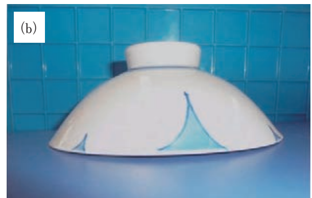
(b)水平な台に置いたとき、変形のため隙間がみられる
