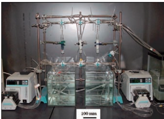
図4 排水高度処理システムの外観
