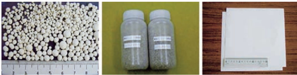
図8 ヒノキチオール-粘土複合試料を配合して作製した造粒品（左）と同フィールド供試料（中），噴霧塗工紙（右）
