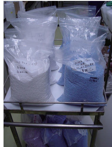
図3 合成したリン吸着材
