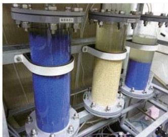
リン吸脱着塔
