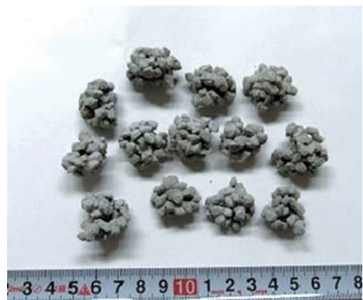
図1 ロウ石を骨材にしたジオポリマー固化体の水熱処理後の試料
