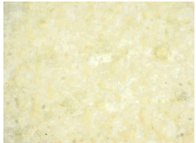
図7 温度差600℃の熱衝撃試験後の試験体表面拡大写真(×175)
