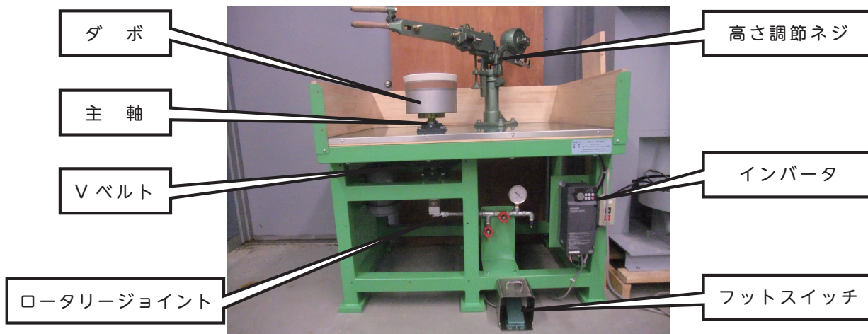
図5 試作した機械ろくろ成形装置
