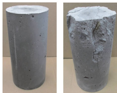
図3 フライアッシュ系ジオポリマーコンクリート 固化体 (左) と圧縮試験後 (右) の様子の一 例 (配合組成は、単位水量 190kg/m 3 , 硬化 液 / 粉末比 0.7)
