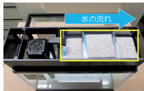
図 2. 光触媒フィルターと小型モジュールの設置(循環水量:30L)
