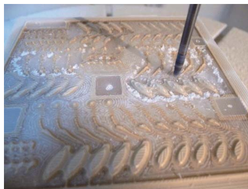
図14 エンドミルの軌跡を示している
