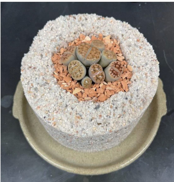
図2 試作品(外径130mm, 内径70mm, 高さ85mm)
